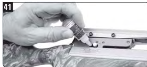
41. Вносите смазку для спускового механизма «Power Touch» сквозь оконце предохранителя
