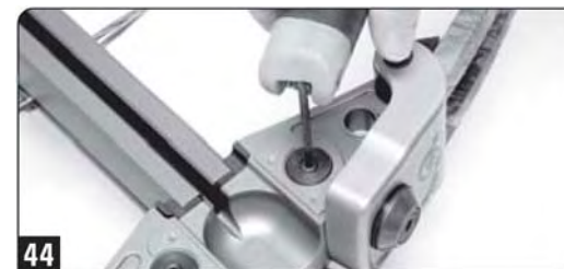
44. Ослабьте затяжные винты, перед тем как начать затягивать либо выкручивать основной крепежный болт или болты, скрепляющие дуги лука (для некоторых моделей арбалетов серии «TenPoint»).
