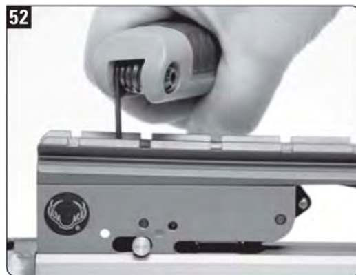
52. У арбалетов, оснащенных спусковым механизмом «PowerTouch» можно добраться до винта, контролирующего величину давления предохранителя, сквозь отверстие в прицельной планке, а у арбалетов со спусковым механизмом «RollerTouch» – сквозь крышку основания для прицела
