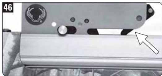
46. DF1 – патентованный предохранитель, защищающий от холостого выстрела
