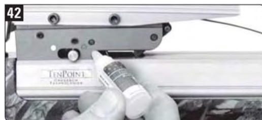
42. Капните каплю смазки прямо в щелевое отверстие спускового механизма, предназначенное для тетивы – как можно ближе к его закрытому концу
