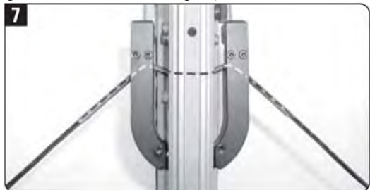
7. Обратите внимание – когда арбалет взводят, тетива натянута чрезвычайно сильно стрелке (на 0,6-1,2 см) и опустите вниз рычажок предохранителя, не ослабив предварительно натяжение, может повредить механизм «ACUdraw». Крепко удерживайте рукоятку, когда опускаете рычажок предохранителя вниз. Сделайте 2,5-3 оборота против часовой стрелки, чтобы снять с тетивы избыточное натяжение. Если вы будете продолжать вращать рукоятку против часовой стрелки после того, как избыточное натяжение сброшено, вы можете повредить механизм «ACUdraw». Снимайте рукоятку только после того, как нагрузка с натяжителя полностью сброшена (илл. 9).
