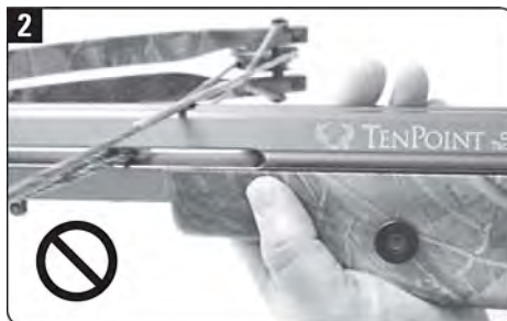
2. НЕВЕРНО. Если ваша рука, держащаяся за цефье, будет расположена, как показано на фотографии, во время выстрела вы серьезно повредите себе пальцы
