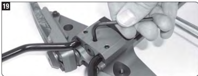
19. После установки стремени затяните все три затяжных винта (этот пункт не относится к арбалету «Phantom CLS»).
