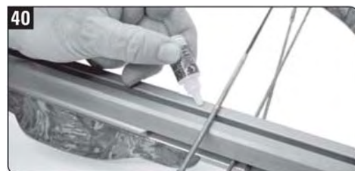
40. Смазывайте направляющую арбалета через каждые 75-100 выстрелов, если вы используете смазку для направляющей, либо через каждые 150-200 выстрелов, если вы применяете «Microlon's Precision Oiler»
