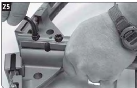
25. Затягивая два больших крепежных болта, свободной рукой прижимайте верхнюю часть ствола к нижней
