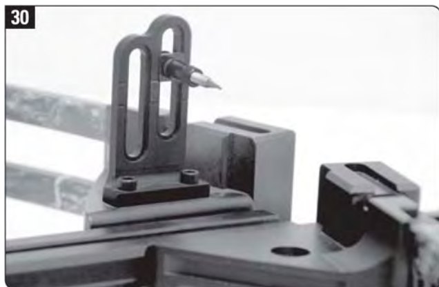
30. Установите намушник с мушкой на левой стороне колодки (для моделей «Titan TL-7» и «Slider»)
